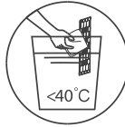
Wyczyść filtr wodą z mydłem i wysusz na powietrzu
