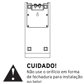
FIGURA 4 INSTALAÇÃO DAS CAIXAS ACÚSTICAS SURROUND EM PAREDE
