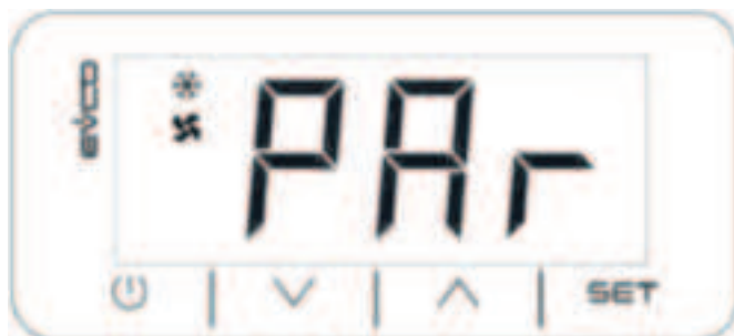
PAr Allows device parameters to be edited
