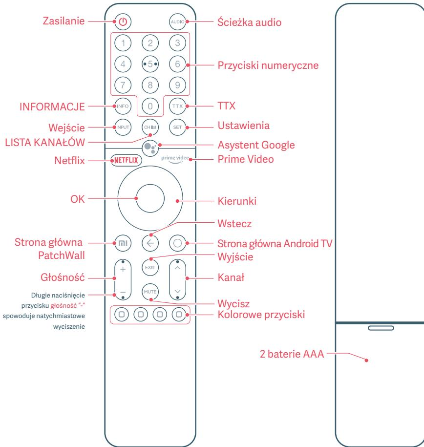
**Zasilanie:** włącza i wyłącza telewizor.
