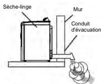
Utilisez un conduit métallique rigide de 10,2 cm de diamètre. Collez du ruban adhésif sur tous les joints, y compris au niveau du sèche-linge. N'utilisez jamais de vis qui retiennent les peluches.
