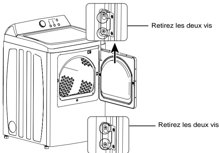
3. Retirez les vis du couvercle du loquet sur le côté droit du sèche-linge et vis du couvercle du casier sur le côté gauche du sèche-linge.
