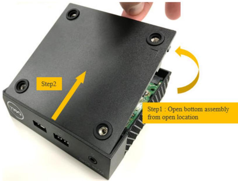
Figure 32. Ouvrir l'assemblage inférieur par la fente d'ouverture
