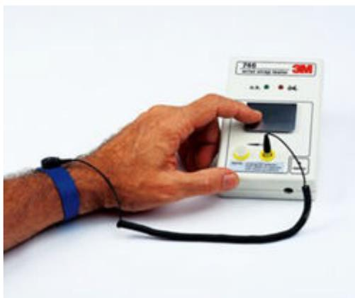
Figure 27. Testeur de bracelet antistatique
