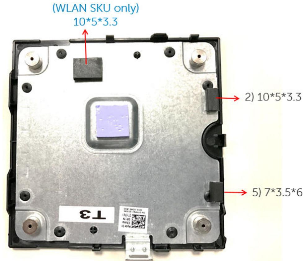
Figure 42. Joint EMI, face inférieure, avec module WLAN
