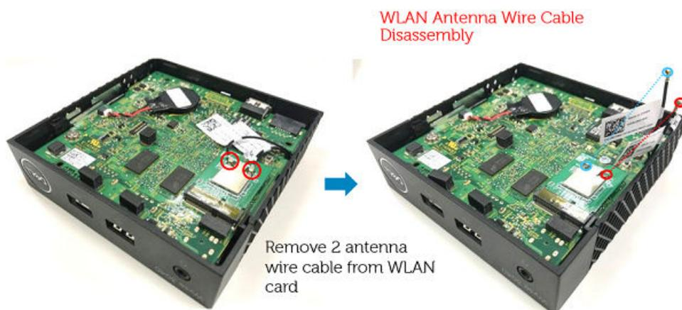
Figure 33. Déconnexion des câbles WLAN
