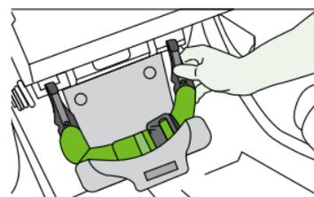
5. **Allongez** la sangle du connecteur inférieur au maximum en appuyant sur le bouton gris de l'ajusteur du connecteur.
