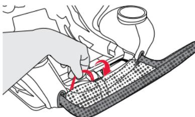
3. **Retirez** la barre anti-rebond. **Appuyez** sur le bouton intérieur rouge. **Tirez** la barre anti-rebond d'un côté. Répétez l'opération de l'autre côté.
