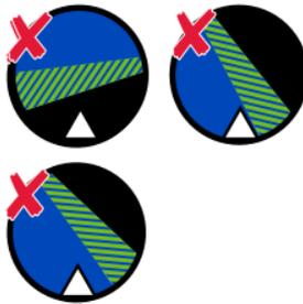
L'indicateur d'inclinaison NE DOIT PAS se trouver dans les sections bleue ou noire.
