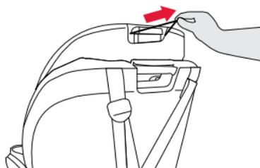
3. **Faites passer** les sangles du harnais à travers les fentes de la housse et attachez les fixations.
