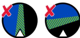
L'indicateur d'inclinaison NE DOIT PAS se trouver dans la section rayée bleu-vert ou la section noire.
