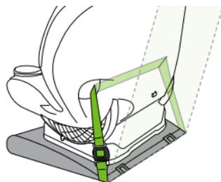
9. **Poussez** vers le bas au milieu du dispositif de retenue pour enfant avec une force modérée (environ 20,4 kg [45 lb]), de manière à comprimer le siège du véhicule tout en serrant la ceinture de sécurité du véhicule.
