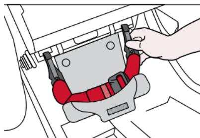
5. **Allongez** la sangle des connecteurs inférieurs au maximum en appuyant sur le bouton gris du dispositif d'ajustement.
