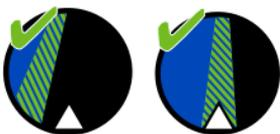
La pointe de l'indicateur d'inclinaison doit se trouver dans la section noire ou la section rayée bleu-vert.
