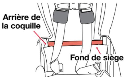
11. Rentrez les languettes de la boucle et les coussinets de confort en les poussant fermement vers le bas dans l'espace jusqu'à ce que la pince de poitrine et l'excédent de courroie ne soient plus visibles.
