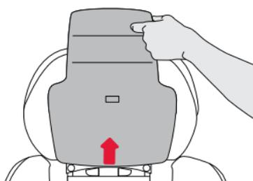
2. **Repliez** la partie supérieure de la housse de fond du siège avec le côté ventilé vers le dessus.
