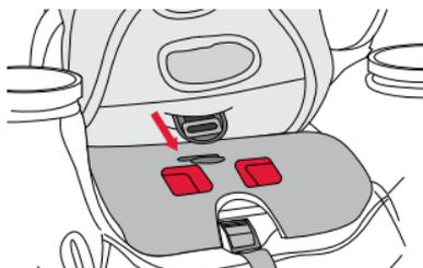
2. **Faites passer** la boucle par la bonne fente de la housse et du CLICKTIGHT. Reportez-vous à la section sur le réglage de la position de la boucle à la page 12.
