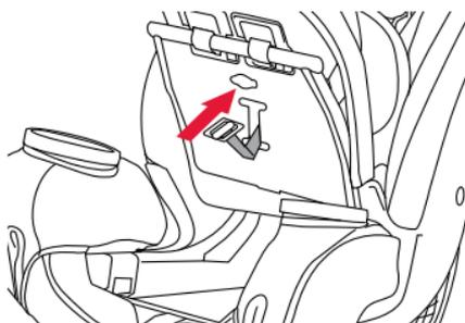
6. **Faites** passer la sangle à travers la housse de siège et les fentes souhaitées, en atteignant de l'autre côté de l'ouverture pour faire passer complètement le support métallique.
