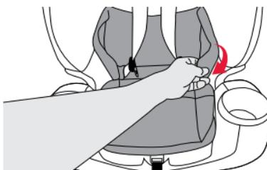
4. **Retirez** la housse loin du harnais et du dispositif de retenue. **Séparez** le coussinet abdominal du reste de la housse (au besoin).
