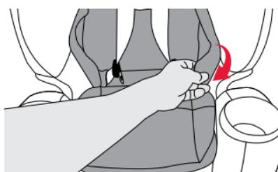
7. **Repliez** la partie supérieure de la housse de fond du siège avec le côté ventilé vers le dessus. Positionnez les sangles du harnais derrière la housse de fond du siège.
