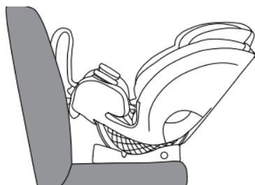
2. **Inclinez** le dispositif de retenue à la position appropriée. Reportez-vous à la page 14 pour déterminer la position d'inclinaison appropriée.
