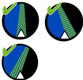
La pointe de l'indicateur d'inclinaison doit se trouver dans la section rayée bleu-vert.
