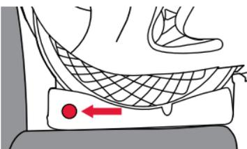
7. **Placez** le dispositif de retenue pour enfant FACE à la route sur le siège du véhicule de manière à ce que la base du siège de la voiture soit à plat sur le siège du véhicule et parallèle au siège du véhicule.
