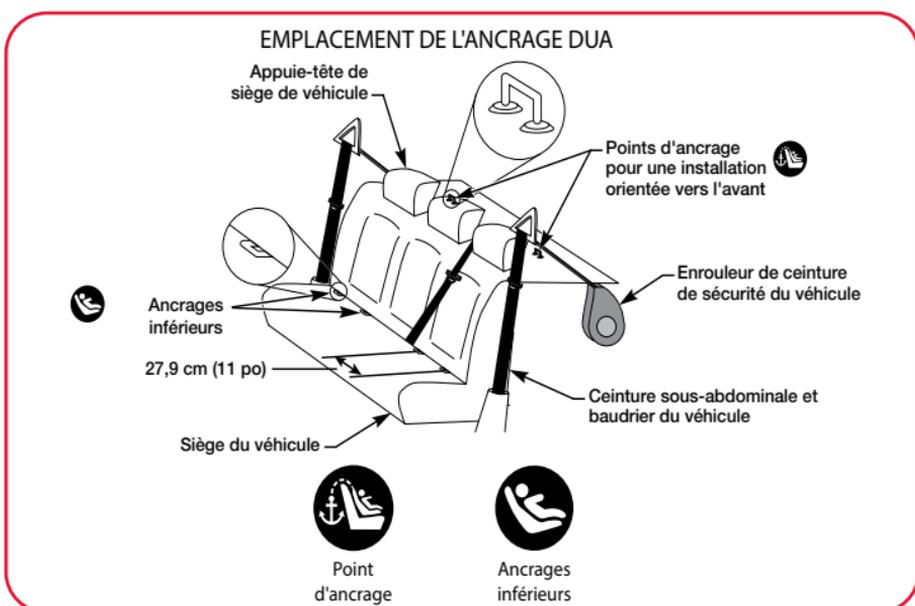
Le dispositif universel d'ancrages d'attaches inférieures (DUA) est un système intégré au dispositif de retenue pour enfants qui offre une solution de rechange aux méthodes d'installation avec la ceinture de sécurité du véhicule. La figure ci-dessus montre les emplacements classiques des barres d'ancrage inférieures et des points d'ancrage dans un véhicule. Reportez-vous aux pages 2 et 3 pour voir les composants du DUA de ce dispositif de retenue pour enfants.
