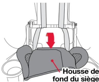
3. **Tirez** les sangles du harnais de l'espace entre l'arrière de la coquille et la partie supérieure arrière du fond de siège.
