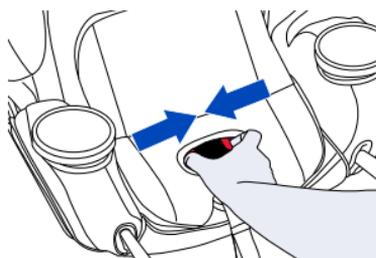
5. **Faites passer** la ceinture sous-abdominale du véhicule par le chemin de ceinture pour l'orientation **VERS L'ARRIÈRE** et marqué par des étiquettes bleues.
