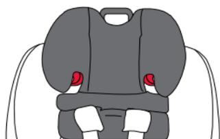
2. **Desserrez** le harnais. Appuyez sur le bouton de déverrouillage du harnais (A) et tirez les deux sangles du harnais vers l'avant (B).
