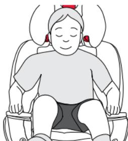
3. **Tirez** sur la ceinture de sécurité du véhicule et faites passer la partie baudrier de la ceinture par le guide rouge de la ceinture baudrier du mode **REHAUSSEUR**.
