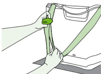
2. **Décrochez** le crochet de la courroie d'ancrage supérieure du dossier du dispositif de retenue pour enfant et placez-le au-dessus du dossier du siège.
