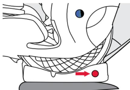
2. **Assurez-vous** que l'angle est correct à l'aide de l'indicateur d'inclinaison situé sur le côté du dispositif de retenue. Regardez directement dans la fenêtre de l'indicateur d'inclinaison et vérifiez que la pointe de l'indicateur est dans la bonne position (reportez-vous aux images ci-dessous).
