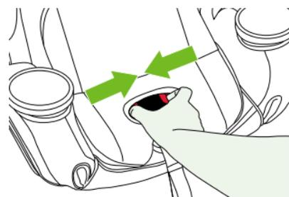
7. **Faites passer** la ceinture sous-abdominale et baudrier du véhicule par le chemin de ceinture pour l'orientation **VERS L'AVANT** et marqué par des étiquettes vertes.
