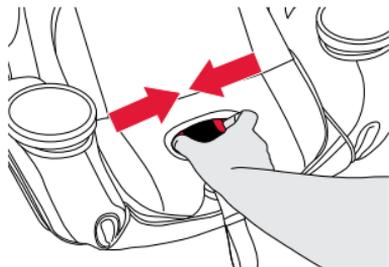
14. Retirez la boucle en faisant tourner le support métallique sur le côté et en le faisant passer à travers les fentes du CLICKTIGHT et de la housse du siège.
