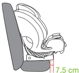
5. **Assurez-vous** que la base ne dépasse pas de plus de 7,5 cm (3 po) le bord avant du siège du véhicule.
