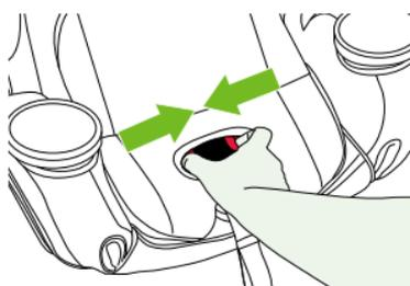
7. **Faites passer** la ceinture sous-abdominale du véhicule par le chemin de ceinture pour l'orientation **VERS L'AVANT** et marqué par des étiquettes vertes.
