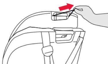
4. **Détachez** les fixations de la housse de l'appuie-tête et retirez la housse loin du dispositif de retenue.
