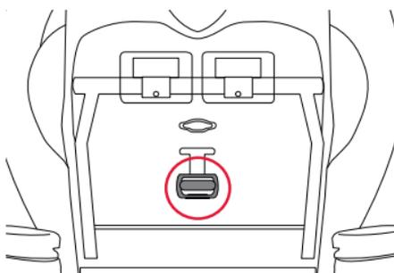
5. **Tournez** le support métallique sur le côté, puis faites-le passer à travers les fentes du CLICKTIGHT et de la housse du siège.
