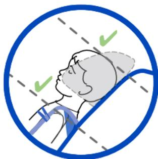
**IMPORTANT :** L'insert inférieur pour bébé fourni **DOIT** être utilisé pour les enfants pesant 10 kg (22 lb) ou moins en position dos à la route. N'utilisez pas un enfant pesant plus de 10 kg (22 lb) en position face vers l'avant.
