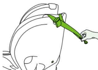
3. **Inclinez** le dispositif de retenue à la position appropriée. Reportez-vous à la page 14 pour déterminer la position d'inclinaison appropriée.
