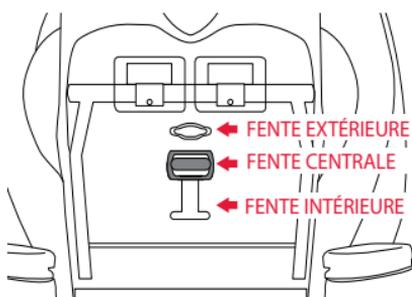
7. **Tirez** doucement sur la boucle pour asseoir le support métallique à plat.
