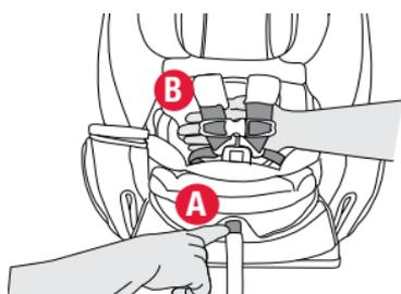
**REMARQUE :** Assurez-vous qu'une longueur de sangle de réglage de harnais suffisante reste suspendue à l'avant du siège. Utilisez la fente intérieure comme point de référence pour mesurer la quantité de sangle du harnais pouvant restée suspendue à l'avant du siège.
