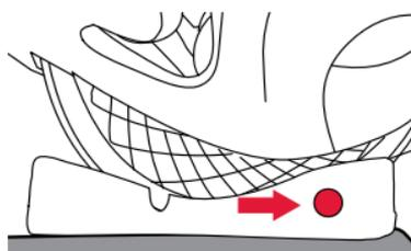
6. **Assurez-vous** que la base ne dépasse pas de plus de 7,5 cm (3 po) le bord avant du siège du véhicule.
