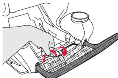
3. **Appuyez** sur le bouton rouge intérieur. **Tirez** la barre anti-rebond d'un côté. Répétez l'opération de l'autre côté.
