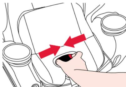
4. **Ouvrez** la pochette de rangement. **Retirez** les connecteurs inférieurs en appuyant sur la languette à ressort, en poussant le connecteur vers l'arrière tout en le faisant pivoter vers le bas et vers l'avant pour le dégager du point d'ancrage.
