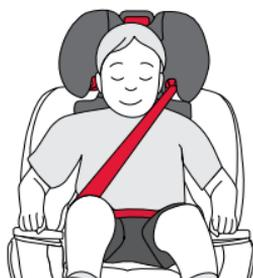
5. **Faites passer** la ceinture de sécurité du véhicule dans le guide de la ceinture sous-abdominale du mode **REHAUSSEUR** et à travers l'enfant.
