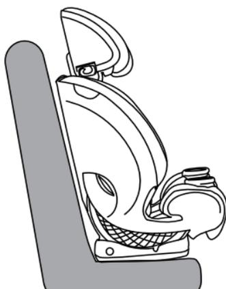
7. **Assurez-vous** que la base ne dépasse pas le bord avant du siège du véhicule.
