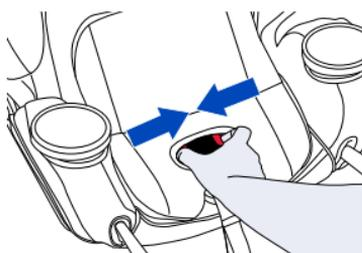
5. **Faites passer** la ceinture sous-abdominale et baudrier du véhicule par le chemin de ceinture pour l'orientation **vers l'arrière** et marqué par des étiquettes bleues.
