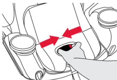
2. **Insérez** la barre anti-rebond dans les deux ouvertures à l'avant du siège.
