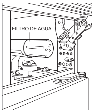
Extracción del filtro de agua.
