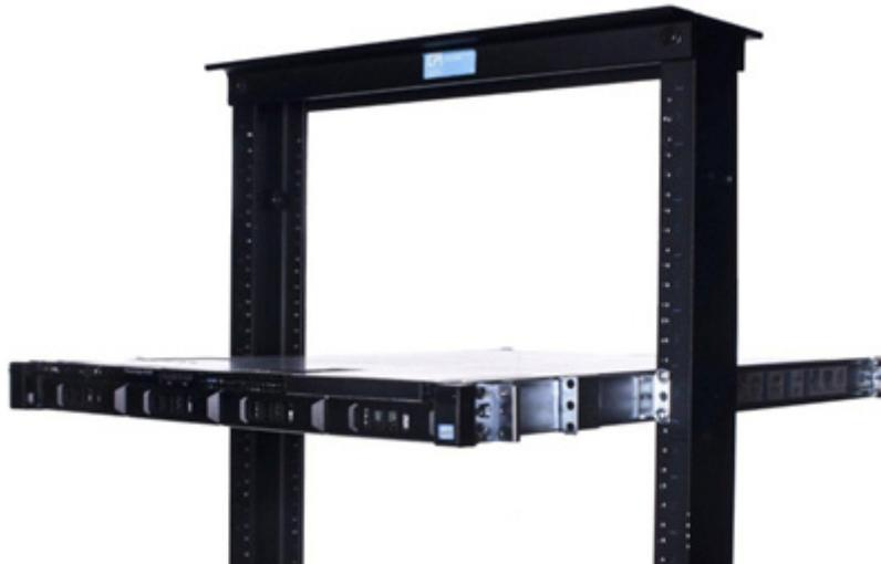
**Abbildung 14. In einer Mittelmontage mit zwei Stützen in statischen Schienen montiertes System**
