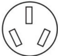
Tomacorriente de 3 hilos (10-50R)
