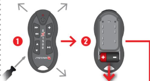
1. Remova a capa de silicone (caso possua) e solte as travas da tampa frontal com o auxílio de uma ferramenta.
