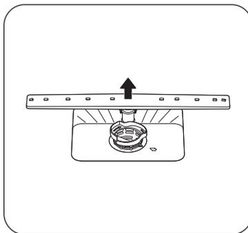
3. Sprüharme in Spülwasser waschen. Düsen mit einer weichen Bürste reinigen. Vor dem Einsetzen Sprüharme gründlich spülen.
