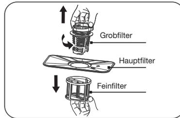
1. Schrauben Sie den Grobfilter entgegen dem Uhrzeigersinn lose. Ziehen Sie den Filter nach oben heraus.
