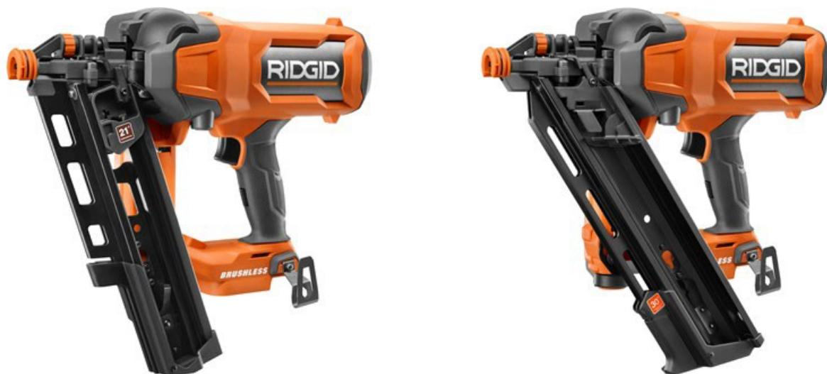
Le système d'engagement à double action des cloueuses peut mal fonctionner et un clou peut être déchargé involontairement en appuyant uniquement sur la gâchette, ce qui présente un risque de lacération pour les consommateurs. Pour décharger un clou, l'élément de contact avec la pièce (nez) de la cloueuse doit être enfoncé et la gâchette doit être actionnée en même temps.
