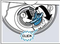
8. Montare il sistema di filtraggio.
