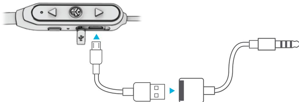
**2** Riprodurre in modalità aereo o da dispositivo mobile con connessione AUX.
