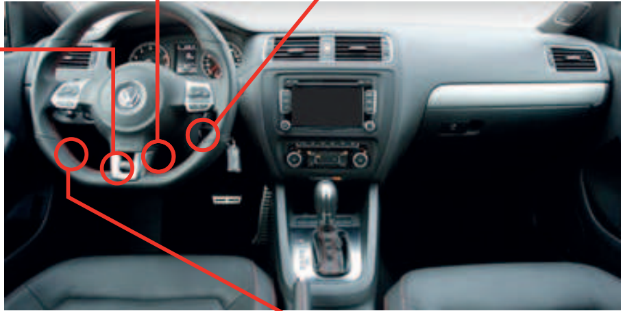
④ OBD-II connector Connecteur OBD-II
