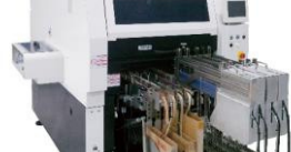
Máy cắm linh kiện có hình dạng đặc biệt
