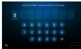
Appuyez sur « next » après avoir saisi le code à 8 chiffres. Le code de l'installateur indique à l'unité si la procédure est effectuée EN LIGNE (en fonction du temps) ou HORS LIGNE (en fonction du compteur).
