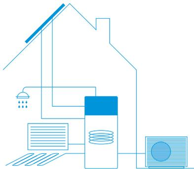
**Console carrossée avec ballon ECH<sub>2</sub>O et possibilité de raccordement à des panneaux solaires thermiques**
