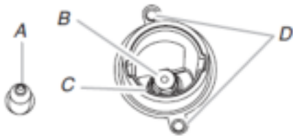
A. Electrodo encendedor B. Tornillo del orificio C. Soporte del tornillo de los orificios D. Tornillos
