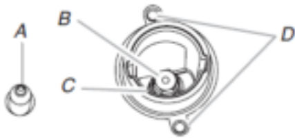
A. Igniter electrode B. Orifice spud C. Orifice spud holder D. Screws
