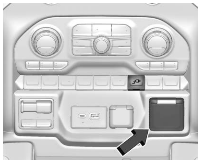
Prise électrique d'habitacle et commutateur c.c./c.a.
