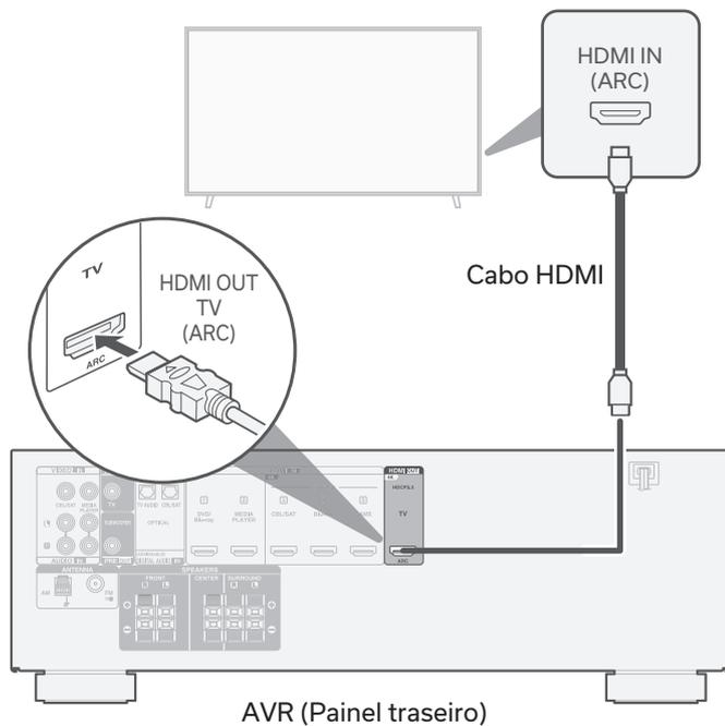
Com um cabo HDMI de alta qualidade\*, ligue uma extremidade à porta HDMI com a etiqueta "ARC" da TV. Ligue a outra extremidade à porta HDMI OUT TV do AVR.
