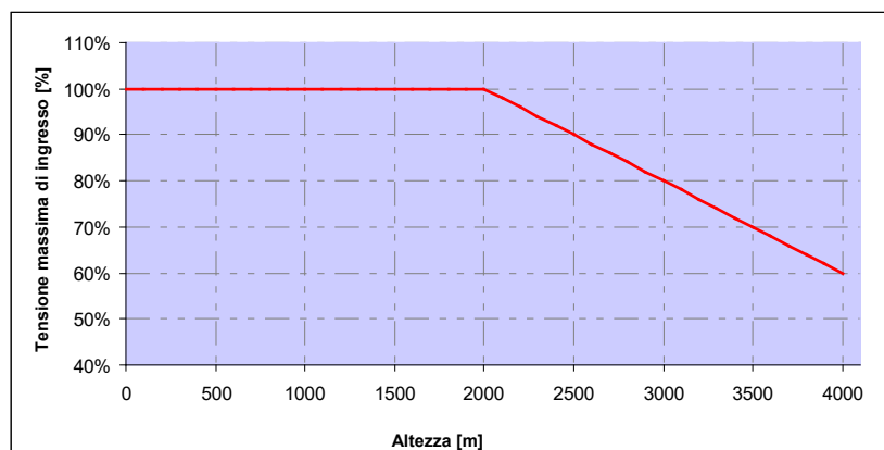
Fig. 51: Derating di potenza della tensione massima in ingresso in funzione dell'altezza di installazione
