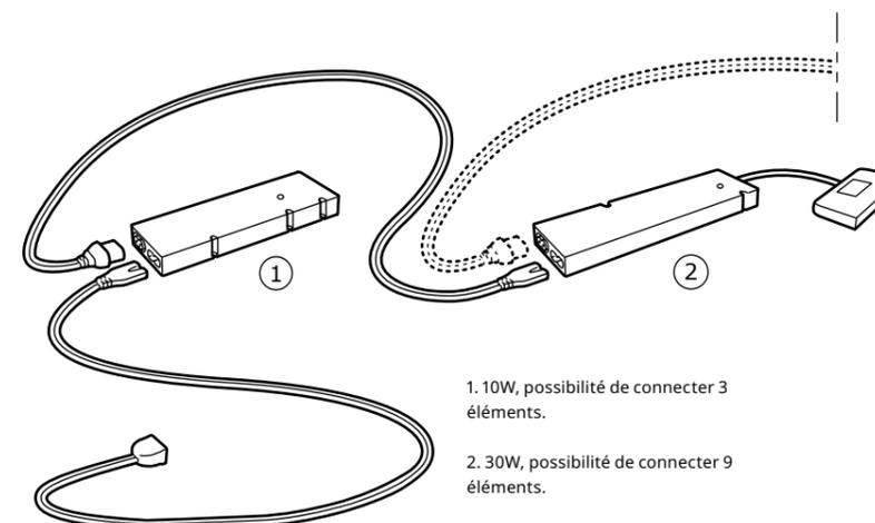
Il existe 2 transformateurs. Choisissez en fonction du nombre d'éléments que vous souhaitez connecter. Vous pouvez connecter jusqu'à 3 éléments au transformateur 10W, à condition que la puissance totale n'excède pas 10W. Le trans-
