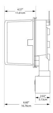
Figure 6.4: Socket Meter in A-Base Side View
