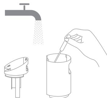
4. Al termine della pulizia, chiudere il coperchio del serbatoio, far scattare il fondo del serbatoio nella posizione di supporto dell'aspirapolvere, e spingere delicatamente il serbatoio fino a sentire un clic che indica che è in posizione.
