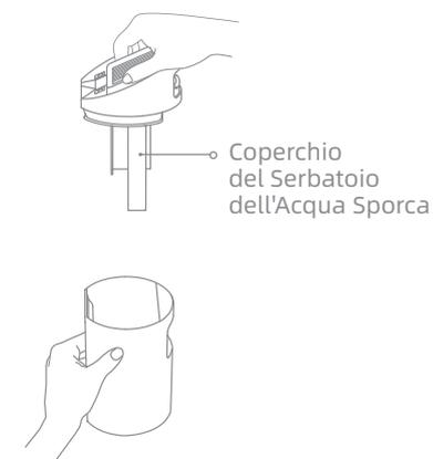
3. Sciacquare il serbatoio e il coperchio del serbatoio con acqua pulita. La spazzola di pulizia inclusa può essere utilizzata per pulire l'interno del serbatoio.
