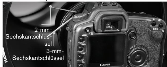
7. Wenn das Sternmuster auf einer Seite dünner ist, stellen Sie die Kollimationsschrauben so ein, dass sich der Stern zur dünnen Seite bewegt und stellen Sie dann die Position des Astrographen ein, um den Stern neu zu zentrieren. Wiederholen Sie diesen Vorgang, bis das defokussierte Sternbild konzentrisch ist.
