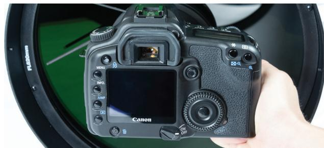
4. Schrauben Sie den Sicherungsring vollständig auf das Gehäuse der Linsengruppe. Drehen Sie den Ring, bis der Kameraadapter fest auf dem Gehäuse sitzt. Nicht zu fest an-
