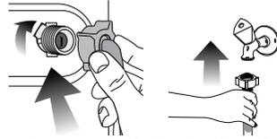
3. Nach dem Anschluss der Schläuche öffnen Sie die Wasserzulaufe (Hähne) komplett und überzeugen sich davon, dass kein Wasser an den Anschlussstellen austritt. Falls Wasser austreten sollte, drehen Sie den Hahn zu und lösen anschließend die Mutter. Überprüfen Sie die Dichtung, ziehen Sie die Mutter anschließend wieder gut an. Um ein Auslaufen von Wasser und daraus entstehende Wasserschäden zu vermeiden, halten Sie die Wasserhähne geschlossen, wenn Sie die Maschine nicht benutzen.
