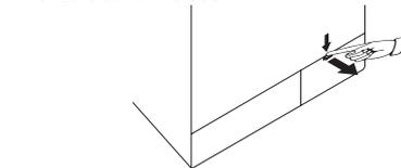
Bei einer einteiligen Filterkappe öffnen Sie die Kappe, indem Sie sie an beiden Seiten nach oben ziehen.
