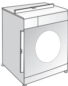
1. Lösen Sie die Kontermuttern an den FüÙen von Hand.
