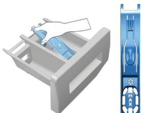
**i** Heben Sie den Siphon wie abgebildet am hinteren Teil an und heraus. Nach der oben beschriebenen Reinigung setzen Sie den Siphon wieder an seinen Platz und drücken sein Vorderteil bis zum Einrasten nach unten.
