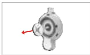
Démonter et nettoyer le mélangeur d'instantané. Voir « Démontage mélangeur d'instantané » ! Veiller à ce que le mélangeur d'instantané soit correctement replacé après nettoyage.
