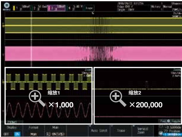
以20毫秒和100微秒跨度显示20秒测量波形的细节。
