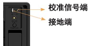
在示波器的侧边可以连接校准方波信号，将探头接在示波器的任一通道，用探头钩勾住下端（校准信号端），将接地夹接到上端（接地端），使用示波器的自动功能，查看测量的波形形状是否为标准方波。
