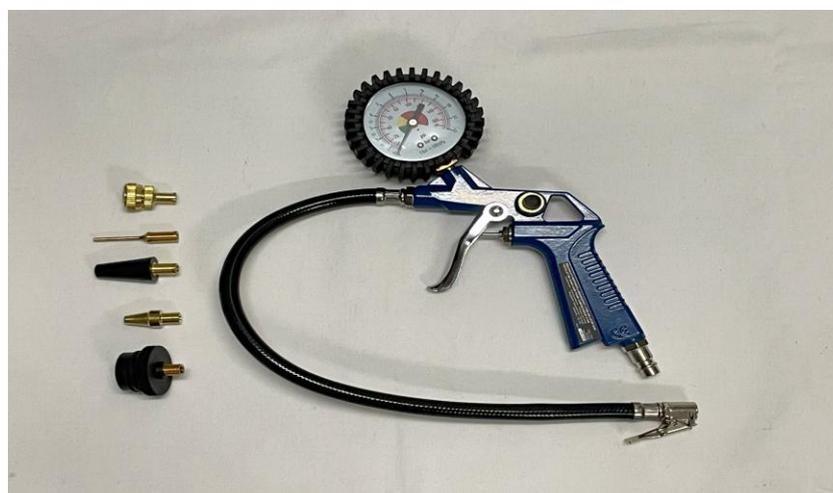
Allerdings werden die **Adapter** mit dem **messingfarbenen Gewinde** nicht eingeschraubt, sondern in den **schwarzen Schlauch** eingeklippt.
