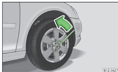
Obr. 151 Výmena kolesa: uvoľnenie skrutiek kolies
