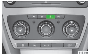
Obr. 91 Tlačidlo pre priame zapnutie/vypnutie prídavného kúrenia (nezávislého kúrenia a vetrania) na ovládacom paneli klimatizácie
