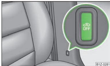
Obr. 15 Tlačidlo stráženia vnútorného priestoru a ochrany proti odtiahnutiu vozidla
