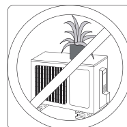
Verificați să nu blocheze nimic zona de admisie și de evacuare a aerului
