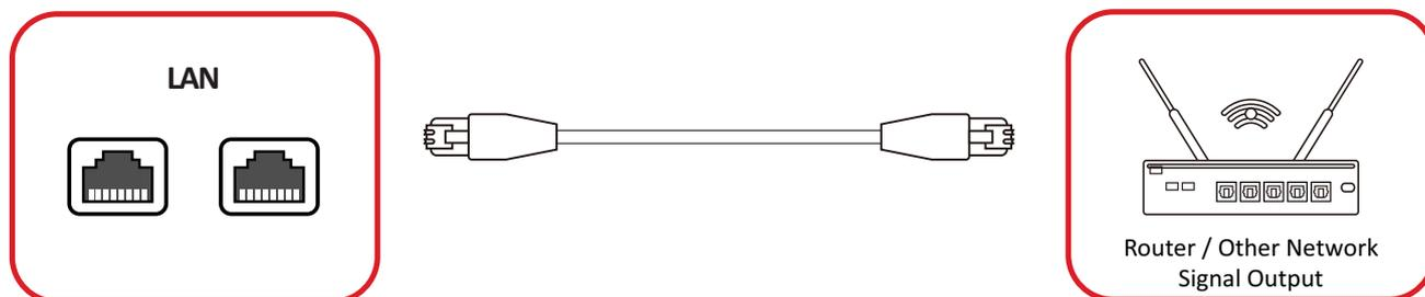
ローカルネットワークに接続するには、ネットワークにイーサネットケーブルを接続し、もう一方の端を ViewBoard の LAN ポートに接続してください。
