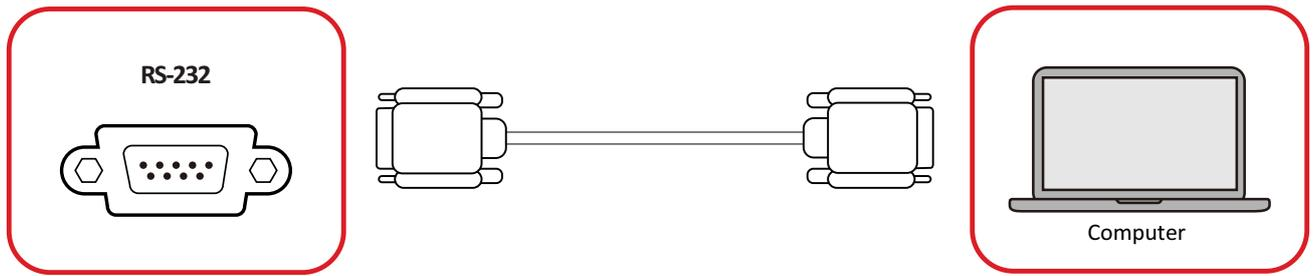
RS-232 シリアルポートケーブルを使用してディスプレイを外部コンピュータに接続すると、電源のオン/オフ、音量調整、入力選択、輝度など、特定の機能をPC からリモートで制御できます。
