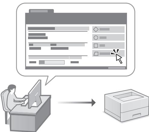
Oddaljeni uporabniški vmesnik omogoča tej napravi, da se upravlja z uporabo spletnega brskalnika na računalniku. Uporabljate ga lahko za preverjanje operativnega statusa naprave in spreminjanje nastavitev.
