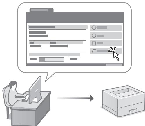
Etäkäyttöliittymän avulla laitetta voidaan hallinta käytämällä tietokoneen selainta. Sitä voidaan käyttää laitteen toimintatilan tarkistamiseen ja asetusten muuttamiseen.
