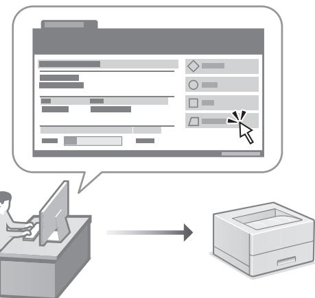
Інтерфейс віддаленого користувача дає змогу керувати апаратом за допомогою браузера на комп’ютері. За його допомогою можна перевіряти робочий стан апарату й змінювати налаштування.
