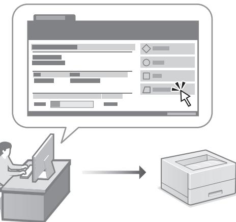
Med fjärranvändargränssnittet kan du hantera den här enheten via en webbläsare på datorn. Du kan använda det när du vill kontrollera enhetens användningsstatus och ändra inställningar.
