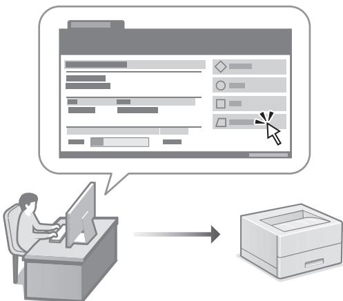
A interface remota permite que este aparelho seja operado através do navegador de Internet de um computador. Pode utilizá-la para verificar o estado de funcionamento do aparelho e mudar as configurações.
