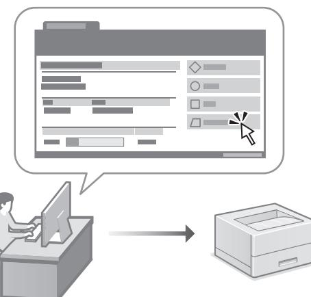
Con la IU remota, se puede gestionar este equipo desde un navegador web en un ordenador. Puede utilizarlo para consultar el estado operativo del equipo y cambiar los ajustes.
