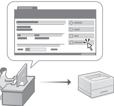
L'IU distante permet de gérer l'appareil depuis un navigateur Web sur un ordinateur. Vous pouvez l'utiliser pour vérifier l'état de fonctionnement de l'appareil et changer les paramètres.
