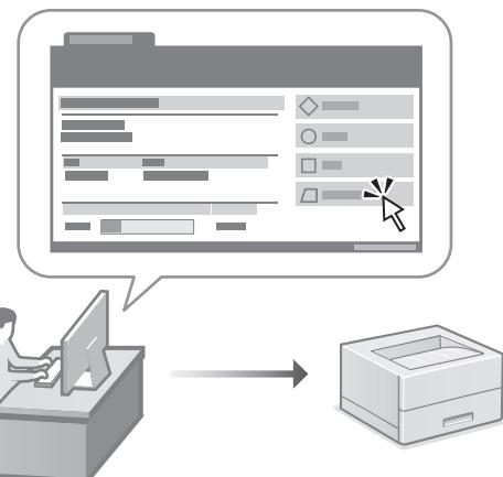
Удаленный ИП позволяет управлять аппаратом с помощью веб-браузера на компьютере. Его можно использовать для проверки рабочего состояния аппарата и изменения его параметров.
