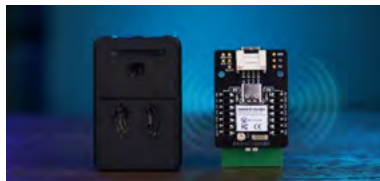
XIAO Sensor de respiración humana y latido de 60 GHz mmWave
