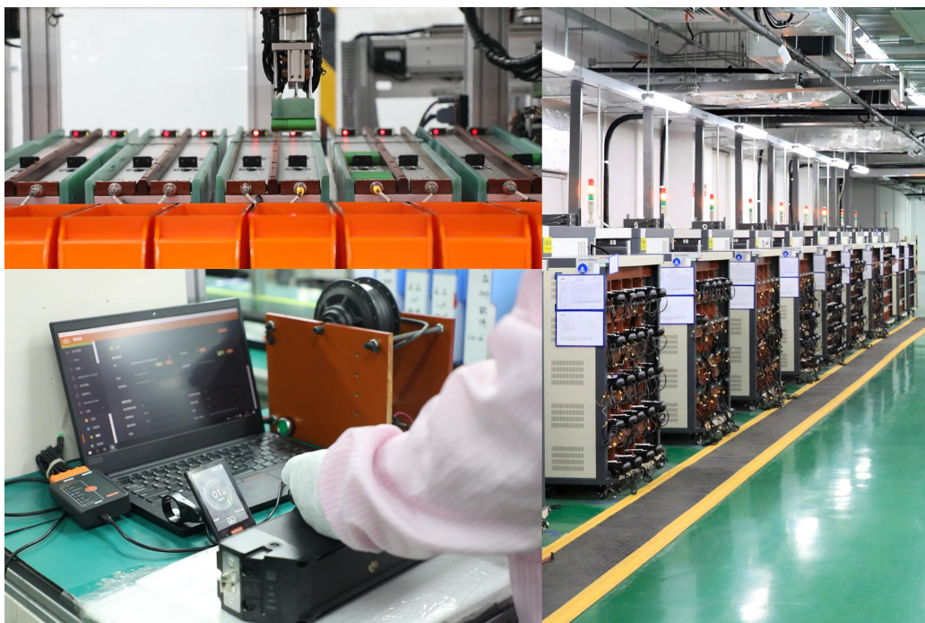
八方电池产线，电芯分选、成套系统匹配验证、充放电循环
