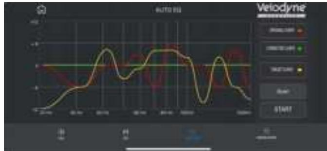
5. Drücken Sie nun die „START“-Taste. Der MiniVee X führt nun mehrere Testton-Sweeps durch und stellt den internen DSP automatisch so ein, dass die Raumkorrektur angewendet wird.
