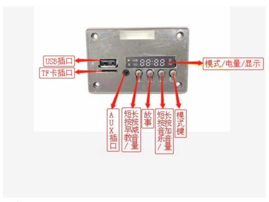
USB 插口: USB Socket TF 卡插口: TF Card Socket AUX 插口: AUX Socket
