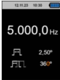
Abb. 7. Schnellmodus – Änderung Phasenverschiebung
