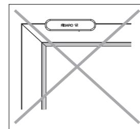
Abbildung 6 – Falsche Montage des Sensors
