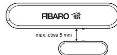
Abbildung 4 – Richtige Lage des Magnets gegenüber dem Sensor
