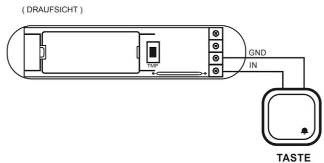
Abbildung 3 – Anschluss der Taste
