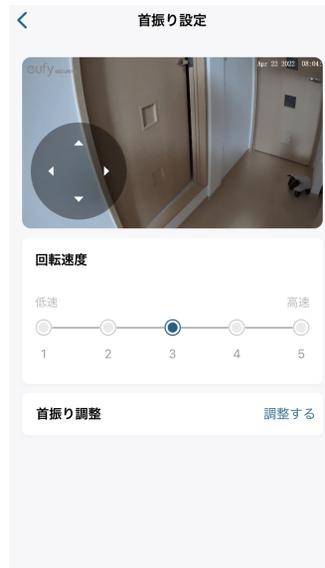
回転速度 | カメラの回転速度を5段階で調整します
