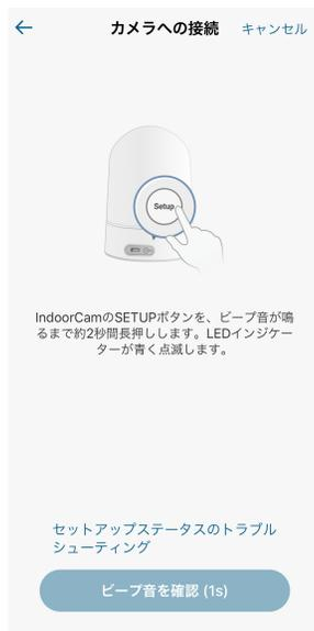
SYNC / SETUPボタンを約2秒間長押しし、LEDインジケータが青くなるのを確認してください
