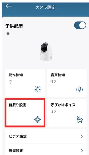
首振り設定 | カメラの首振りの調整や回転速度設定
