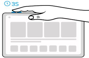
Drücken Sie die Tasten **Lauter** und **Leiser** gleichzeitig 3 Sekunden lang, um die Bedienungshilfen zu aktivieren.
