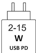
Die vom Ladegerät abgegebene Leistung muss zwischen 2 Watt, die vom Funkmodul benötigt wird, und 15 Watt liegen, um die maximale Ladegeschwindigkeit zu erreichen.
