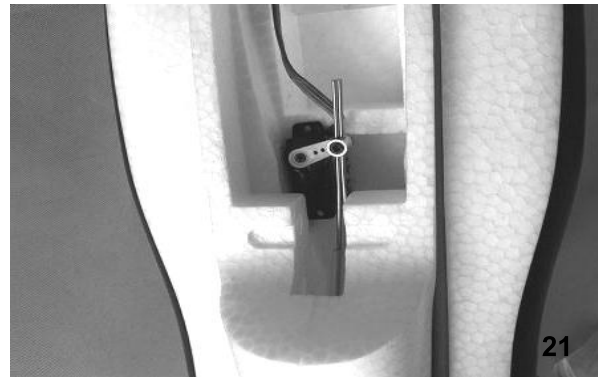
Bild 21 – Verbinden Sie die Anlenkstange mit dem Servo.
