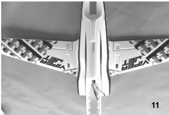
Bild 11 - Das Foto zeigt die fertige Ansicht nach dem Einkleben der Flügel.
