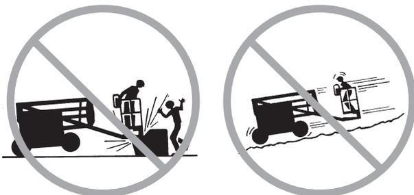
Limite a velocidade do percurso de acordo com as condições da superfície do solo, de congestionamento, inclinação, localização de pessoas e quaisquer outros fatores que possam causar colisão.
