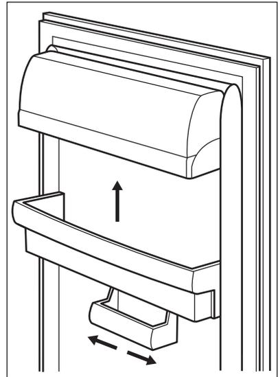
Dieses Modell ist mit einer variablen Lagerbox ausgestattet, die seitlich bewegt werden kann.
