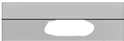
4. En la pared o pantalla se observará un patrón de luz con un borde claro horizontal hacia la derecha. Si este borde no está en la línea de referencia horizontal, se deberá ajustar el rayo de modo que el borde esté a la misma altura que la línea de referencia horizontal.
