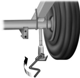
Puntos de ubicación del gato en el eje trasero: todos los modelos excepto el E-350 de doble rueda trasera y el E-450
