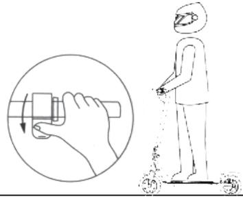
3. Cuando el scooter empiece a avanzar por inercia, ponga los dos pies en la plataforma y pise el acelerador (el acelerador se pone en marcha cuando la velocidad de avance por inercia supera las 3 mph)
