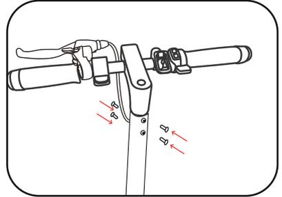
Paso 2. Inserte los 4 tornillos en los orificios, y luego ajuste cada uno.
