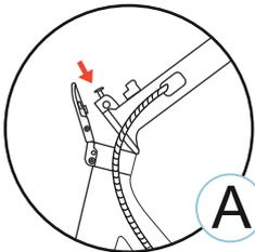
A) Si el mecanismo de sujeción está muy suelto o ajustado, regule los tornillos plateados para aumentar o reducir su altura (Imagen A).
