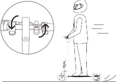
4. Suelta el acelerador y el sistema de recuperación de energía cinética (KERS) se pone en marcha automáticamente para frenar lentamente; y aprieta la palanca de freno para frenar de golpe.
