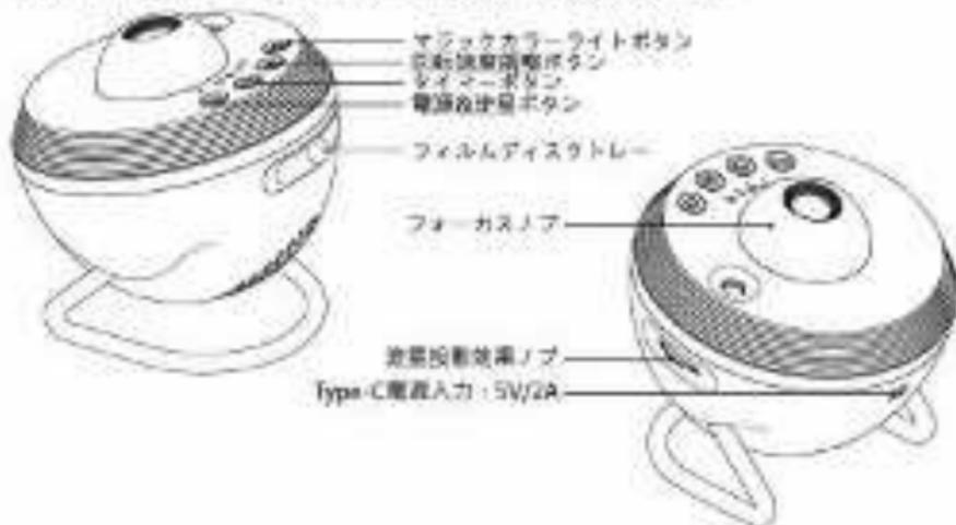
(1) **電源&流星ボタン**：長押しして電源をオン/オフにします。短押しして流星効果をオン/オフにします。流星効果をオンにすると流星表示LEDが点灯し、オフにすると流星表示LEDが消灯します。
