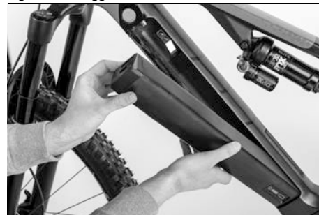
Fig. 28: Montaggio della batteria di trazione
